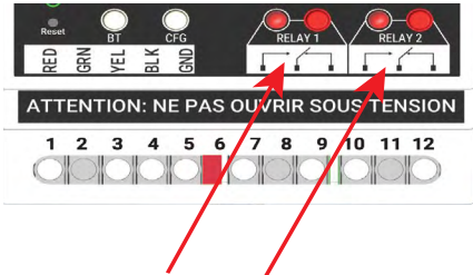
Figure 6. L'étiquette des connexions des relais d'alarme indique l'état du relais lorsque le TTSIM-3/4 est sous tension, qu'aucune alarme n'est présente et que l'état du relais d'alarme est programmé sur Arrêt (réglage par défaut).
